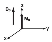
この図は、z方向に与えた磁場 $B_0$ 中にあるスピン1/2の単一核(水素核)の磁化ベクトルを示している。この磁化ベクトルに $40^0$ yパルスを与えたのち、この磁化ベクトルのx、y、z方向の成分は各々どのような値になるかを答えなさい。ここで、 $40^0$ yパルスのハミルトニアンH(t)はH(t)= $\alpha I_y$ ( $\alpha$ = $40^0$ )と表される。
